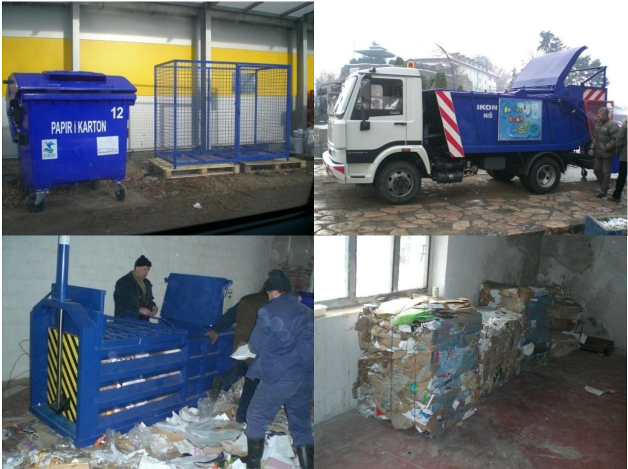
Fig.2-5: raccolta differenziata a Novi Pazar: cassonetti, gabbie, veicolo di raccolta, pressa orizzontale e balle di carta recuperata prodotte.
